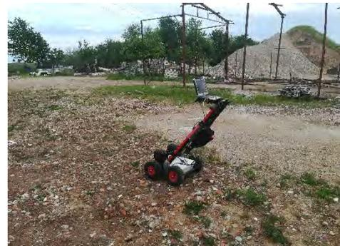
I profili G.P.R. realizzati non hanno evidenziato alcuna anomalia significativa nella zona interessata dalle verticali d'indagine relative ai sondaggi a carotaggio continuo ed alle prove penetrometriche dinamiche pesanti DPSH.
