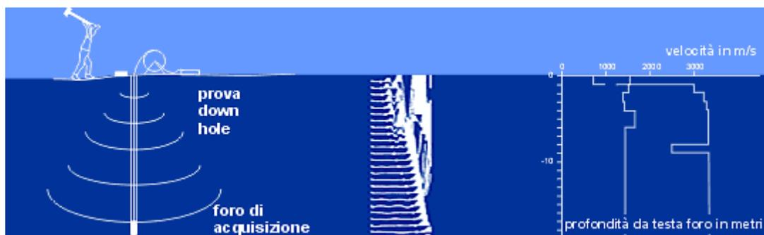
Le onde di taglio hanno velocità inferiori a quelle compressive e quindi raggiungeranno la terna geofonica quando già il primo fronte d'onda compressiva è già transitato. Questo passaggio costituisce
